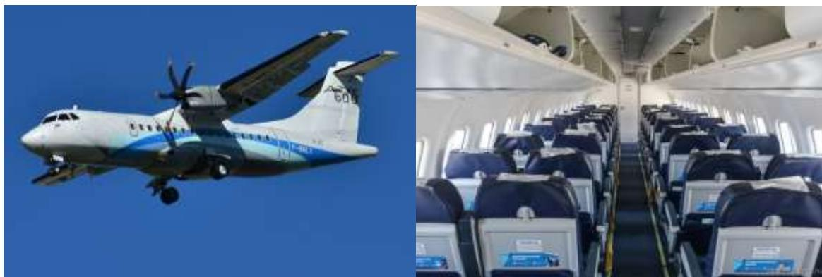
Сборка этой модели происходит в Тулузе. Проект по разработке самолета был открыт в 1981 г. ATR 42 был сертифицирован в 1985 г. Базовая версия самолета рассчитана на перевозку 42 человек. Максимальное расстояние равно 1500 км, а средняя скорость самолета составляет 450 км/ч. Уникальная конструкция крыла обеспечивает ему хорошую устойчивость даже на небольших скоростях (при посадке).
